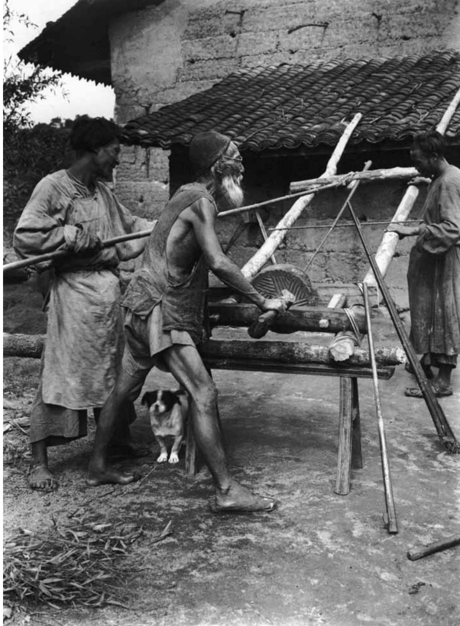
2. Un anziano armaiolo fabbrica la canna di un fucile aiutato dai figli. L'immagine è stata scattata nel 1903 da padre Leone Nani, grande fotografo e missionario in Cina.
