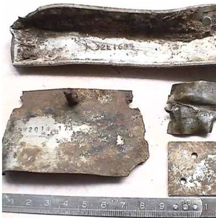
Frammenti della struttura con matricole. Il prefisso 32 indica che il pezzo fa parte di un B-24
